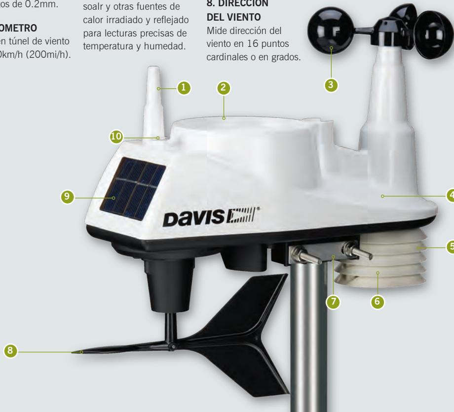
« El módulo de sensores se monta en postes de 2.54cm a 4.45cm (1.00" a 1.75") de diámetro (el poste no se incluye).
