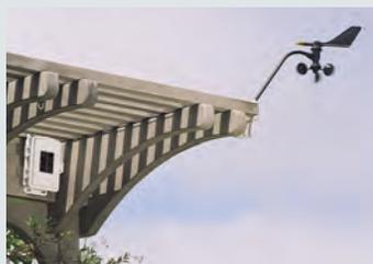
Aleje el Anemómetro Vantage Pro2 hasta 300m (1,000ft) con un Transmisor de Sensores.
