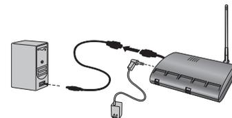
Instale una Weather Envoy cerca de su computadora usando el cable USB incluido y adaptador AC
